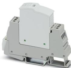
Parafoudre basse tension de type 2/3 composé d'une fiche de protection et d'un élément de base pour indicateur d'état intégré et signalisation à distance pour les réseaux d'alimentation monophasés. Tension nominale : 120 V AC/DC
