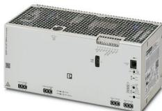
Alimentation sans interruption avec technologie IQ pour le montage sur profilé. Entrée : 120 / 230 V AC, sortie : 120 / 230 V AC / 1 kVA. Indication constante du niveau de charge, de l'autonomie restante et de la durée de vie du module accumulateur, ce qui augmente la disponibilité de l'installation.
