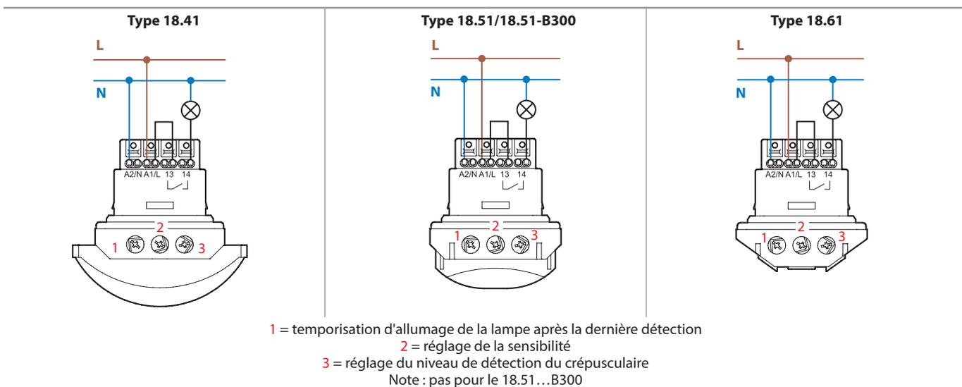
La puissance nominale indiquée dans les spécifications pour la commutation de lampes s'entend si le raccordement est effectué selon les schémas ci-dessus. Si les lampes sont alimentées par une phase différente de celle alimentant le détecteur de mouvement, il faut alors réduire de 50% la puissance des lampes à commuter.
