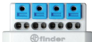
Les bornes doubles facilitent les pontages ou le raccordement d'autres produits en parallèle. Chaque borne accepte un câble de 2.5 mm<sup>2</sup> de section.
