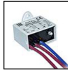
S.2499 DÉCHARGEUR DE SURTENSION 10kV CLASSE II Compatible avec tous les appareils d'éclairage et alimentation électrique en classe d'isolation CLASSE II Tension de fonctionnement 230-277V SPD type 2+3 Tension maximale de décharge 10kV Indice de protection IP67 IL FAUT PRÉVOIR POUR CHAQUE APPAREIL D'ÉCLAIRAGE UN DÉCHARGEUR DE SURTENSION; IL DOIT ÊTRE INSTALLÉ À UNE DISTANCE MAXIMALE DE 10m DE CE DERNIER.
