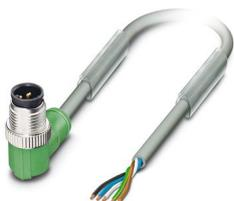
Câble pour capteurs/actionneurs, 5-pôles exempt d'halogène, ultra-souple, connecteur mâle coudé M12, détrompage: A, câblé avec déconnecté, sur extrémité libre, longueur de câble: 1,5 m, pour robots et chaînes porte-câbles
