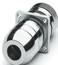
Traversée face avant, droit, Verrouillage à baïonnette, type de contact: Connecteur femelle, plage de diamètre de câble: 2 mm ... 14,5 mm, nombre de pôles: 17, type de raccordement: Raccordement à sertir
