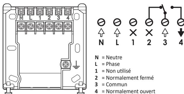
**Note :** Ce socle bénéficie d'une double isolation, un raccordement à la terre n'est donc pas nécessaire.
