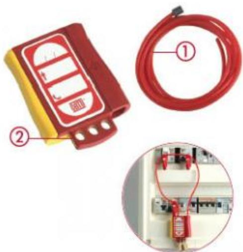
S'adapte sur tous types de condamneur d'organe de protection B.T. Particulièrement adapté au condamneur de disjoncteurs CLIPBLOCK™. Cordon PVC haute résistance, Ø 4mm. Corps en ABS pour utilisation avec cadenas jusqu'à 6 mm. Livré sans cadenas ni condamneur AL-201.
