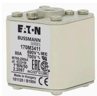
**Cartouche fusible, grande vitesse, 80 A, AC 690 V, compact size 1, 45 x 59 x 51 mm, aR, IEC, UL, M8, corps carré avec contacts affleurants**
