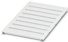
Repères pour blocs de jonction, Planche, blanc, vierge, repérable avec : BLUEMARK ID COLOR, BLUEMARK ID, BLUEMARK CLED, PLOTMARK, CMS-P1-PLOTTER, type de montage: encliquetage, pour bloc de jonction au pas de : 4,2 mm, surface utile: 3,6 x 10,5 mm, Nombre d'étiquettes: 120
