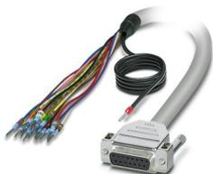
Câble rond blindé préconfectionné; raccordement 1 : Fils individuels (15-pôles) (Les fils sont repérés et équipés d'embouts. La tresse de blindage sort d'une extrémité de câble distincte.); raccordement 2 : Connecteur femelle D-SUB (1x 15-pôles); longueur de câble: 0,5 m
