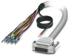
Câble rond blindé préconfectionné; raccordement 1 : Fils individuels (15-pôles) (Les fils sont repérés et équipés d'embouts. La tresse de blindage sort d'une extrémité de câble distincte.); raccordement 2 : Connecteur femelle D-SUB (1x 15-pôles); longueur de câble: variable
