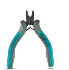
Pince coupante diagonale électronique ESD, tête arrondie, sans chanfrein, avec ressort d'ouverture, antireflet et phosphatée, poignée à 2 éléments, capacité de coupe : souple 0,2 - 2,0 mm ; dureté moyenne 1 mm de diamètre
