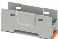
Boîtier électronique sur rail DIN, Partie inférieure du boîtier avec base encliquetable, design plat, largeur: 22,6 mm, hauteur: 75 mm, profondeur: 30,3 mm, coloris: gris clair (7035)
