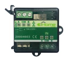
Interface à 2 sorties relais 10A NO/NF configurables avec un seul commun. Pour commander des volets roulants ou de l'éclairage. Ne convient pas pour la commande de lampes fluorescentes, à leds ou de fortes charges. À relier sur sorties Open Collector 24Vcc (par exemple art.20004601 ou art.20046502). Montage par encastrement ou sur rail DIN. Dimensions 42x42x18mm (1 module DIN).
