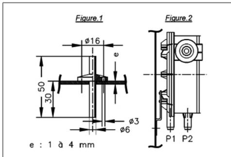
Veillez à passer le tube flexible dans l'un des presse-étoupe fournis avec le coffret de relayage, afin de conserver le degré d'étanchéité IP du coffret.
