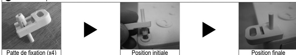
**2** A l'aide d'un marteau, enfoncer la tige de la patte de fixation jusqu'à ce que celle-ci ne soit plus visible.
