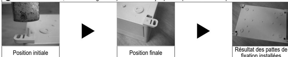
Remarque : les pattes de fixation peuvent être placées en position verticale ou horizontale.
