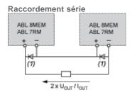
(1) Deux diodes Schottky Imin = In d'alimentation et Vmin = 50 V
