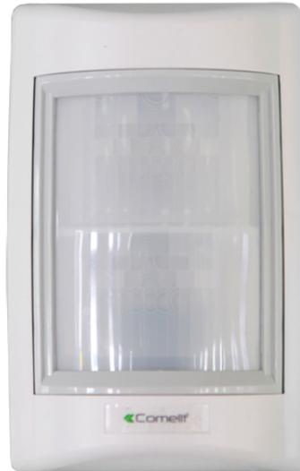
Détecteur double IR grand-angle à double élément d'extérieur en technologie ASIC permettant une analyse précise pour éliminer les fausses alarmes, alimentation de 9,6 à 16 Vcc, consommation au repos 18 mA, en condition d'alarme 8 mA, couverture 16 m, ouverture 110°, température de service de -25 à +55°C, protection IP 65, sortie alarme et contact de sécurité NF.
