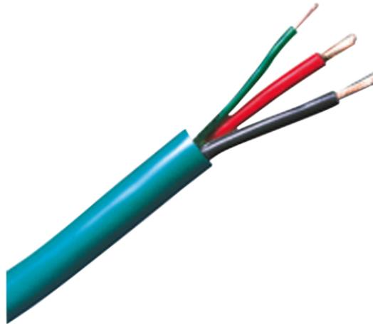
Câble de connexion des modules communiquant sur le BUS 3 fils du système SimpleHome. 2 conducteurs de 1mm<sup>2</sup> pour l'alimentation et 1 conducteur de 0,5mm<sup>2</sup> pour le bus de communication. Blindage en aluminium. Bobine de 100m.
