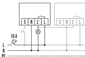
Raccordement avec commande optionnelle par poussoir. Mise en parallèle de 10 appareils au maximum.
