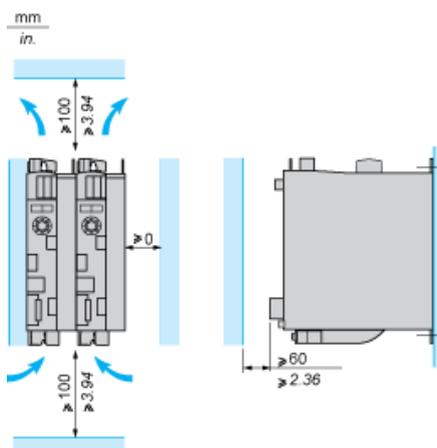
Les servo variateurs LXM32•U45M2, •U90M2 and LXM32•U60N4 sont refroidis par convection naturelle. Les servo variateurs LXM32•D18M2, •D30M2, LXM32 •D12N4, •D18N4, •D30N4 et •D72N4 possèdent un ventilateur intégré.
