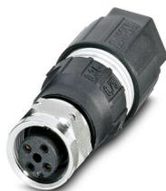
Connecteur, Universel, 4-pôles, connecteur femelle droit M12, A, Raccordement autodénudant, matériau de la molette: Acier inoxydable 1.4404, diamètre extérieur du câble 4 mm ... 8 mm
