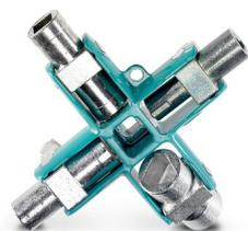
Clé pour armoire électrique, en métal, pour toutes les serrures courantes : double panneton 3-5 mm, quatre pans 5,6,7-8,9-10 mm, trois pans 7,8-9,10-11 mm, spéciale 6 mm
