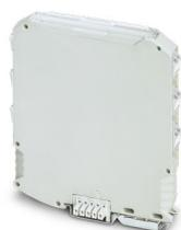
Boîtier électronique sur rail DIN, Boîtier complet avec pied métallique de verrouillage, design élancé, avec option TBUS, sans fente d'aération, largeur: 12,6 mm, hauteur: 99 mm, profondeur: 113,65 mm, coloris: gris clair (7035), connexion transversale: Connecteur de bus sur rail DIN (en option), nombre de pôles connecteur transversal: 5
