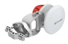
Antenne à faisceau symétrique de 90° avec gain : 9,6 dB. Dotée de connecteurs N-femelle, fréquence 5180 - 6400 MHz, largeur de faisceau -6 dB : H 90° / V 90°, inclinaison mécanique :  $\pm$  25°, diamètre de montage sur mât : 30- 80 mm.
