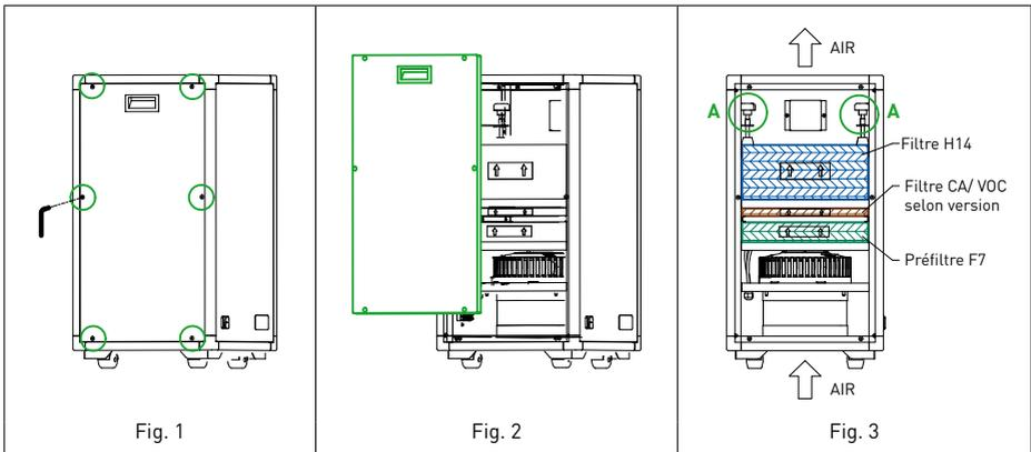
Lors de l'installation des nouveaux filtres, assurez-vous que la direction de l'air de l'étiquette du filtre correspond avec le flux d'air dans l'unité. Après maintenance / remplacement des filtres suivez les étapes ci-dessus dans l'ordre inverse avant de redémarrer l'unité.
