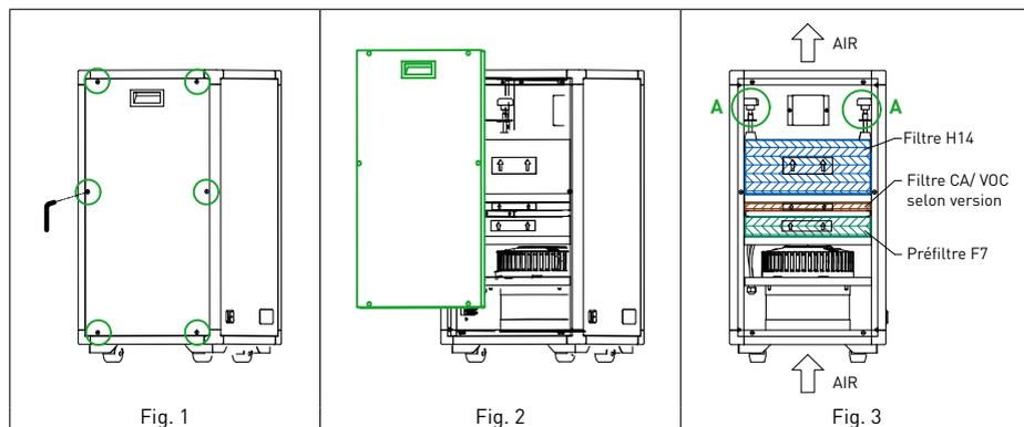
Lors de l'installation des nouveaux filtres, assurez-vous que la direction de l'air de l'étiquette du filtre correspond avec circulation d'air dans l'unité. Une fois les filtres sont déballés et mis en place, l'unité est prête à démarrer. Branchez le câble d'alimentation sur le secteur et actionnez l'interrupteur marche / arrêt. Puis ajustez ensuite le débit d'air en fonction des besoins de la pièce (voir ci-dessous point).
