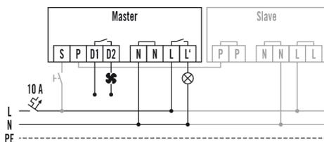
Raccordement maître/esclave avec commande optionnelle par poussoir. Un appareil maître peut être raccordé à 6 appareils esclaves au maximum.
