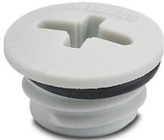
Vis de fermeture, matériau du raccordement vissé: PA, filetage de raccordement: M12 x 1,5, coloris: gris clair RAL 7035, avec joint torique
