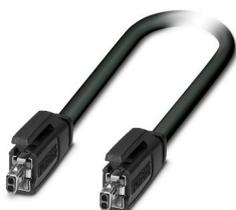
Câble de jonction, type: IEC 63171-2, indice de protection: IP20, longueur de câble: 2 m, nombre de pôles: 2, 1 Gbit/s, CAT B, matériau: TPU, type de raccordement: Raccordement à sertir, section raccordable: AWG 22- 22, sortie du câble: droit, Single Pair Ethernet
