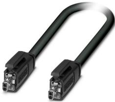
Câble de jonction, type: IEC 63171-2, indice de protection: IP20, longueur de câble: 3 m, nombre de pôles: 2, 1 Gbit/s, CAT B, matériau: TPU, type de raccordement: Raccordement à sertir, section raccordable: AWG 22- 22, sortie du câble: droit, Single Pair Ethernet
