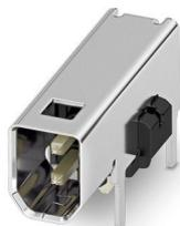
Connecteurs pour circuits imprimés du dispositif de protection sensible, type: IEC 63171-2, indice de protection: IP20, nombre de pôles: 2, 1 Gbit/s, CAT B (ISO/IEC 63171), matériau: Métal, type de raccordement: Raccordement soudé THR, sortie du câble: droit, Single Pair Ethernet
