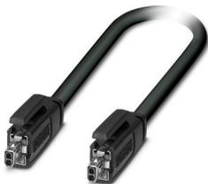
Câble de jonction, type: IEC 63171-2, indice de protection: IP20, longueur de câble: 5 m, nombre de pôles: 2, 1 Gbit/s, CAT B, matériau: TPU, type de raccordement: Raccordement à sertir, section raccordable: AWG 22- 22, sortie du câble: droit, Single Pair Ethernet
