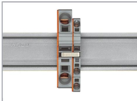
Les ponts réducteurs sont conçus pour la connexion entre les bornes de passage de grandes sections et de petites sections, sans perte de points de connexion. Ils ont par ex. un intérêt lorsque pour de grandes longueurs de conducteurs la chute de tension doit être maintenue faible, mais que « sur place » la section nominale suffit.
