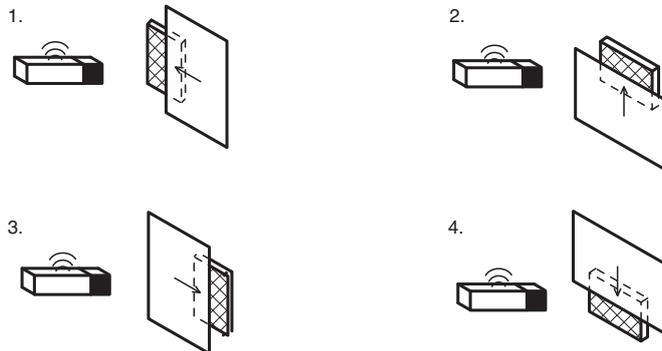
Le réflecteur est occulté lentement par un objet (p.e. une feuille de papier) déplacé latéralement jusqu'à ce que la cellule commute. L'orientation de la cellule est optimale si son point de commutation dans chaque direction de déplacement de l'objet est situé au même degré d'occultation du réflecteur.
