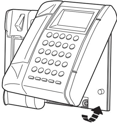
La boucle de connexion doit être fixée en pose murale avec l'adhésif double face fourni ou avec les vis et les chevilles.
