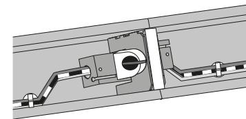
Ⓛ Zur Vermeidung von EMV-Problemen darf die Durchgangsverdrahtung in Leuchten mit EVG nicht direkt parallel zu den Lampenleitungen verlegt werden. Vorgesehnen Leitungshalter verwenden. Funktionserdanschlüsse mit Erde verbinden. Leitung nicht am Vorschaltgerät vorbeiführen.
