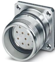
M23, Embases paroi avant, série: RC, droit, blindé: oui, Verrouillage à vis, Nombre de pôles: 16+3, Sens de rotation: standard, type de contact: Connecteur femelle, Cône de soudage, Joint plat, 4x Ø2,7, détrompage: N, Produit de remplacement selon RoHS II sans exception 6c (Pb < 0,1 %) référence : 1241532
