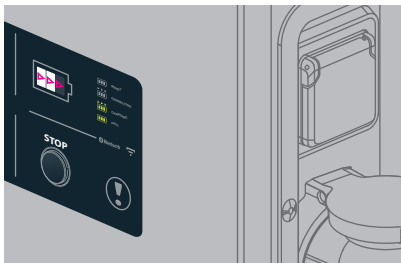
"Borne connectée au véhicule" en attente de charge (défilement blanc) (0 à 30" selon véhicules)
