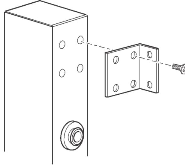
2. Fixez la PDU à l'un des rails de montage verticaux à l'arrière de l'armoire à l'aide de deux vis supplémentaires par support (non fournies).
