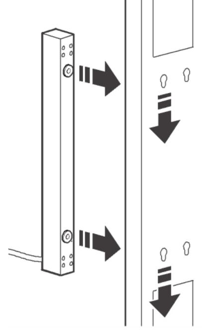
**Remarque :** il est possible de monter deux PDU en rack sur un côté de l'armoire en utilisant la méthode de montage sans outil.
