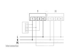
Raccordement sur 230 V. Option possible : mise en réseau de 30 détecteurs max. / relais PROTECTOR K (max. 300 m de câblage)
