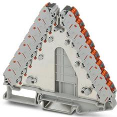
Distributeurs de potentiel, tension nominale: 250 V, intensité nominale: 17,5 A, type de raccordement: Raccordement Push-in, 1., 2., 3., 4., 5., 6., 7. und 8. Etage, Section de référence: 1,5 mm<sup>2</sup>, section : 0,14 mm<sup>2</sup> - 2,5 mm<sup>2</sup>, montage: NS 35/7,5, NS 35/15, coloris: gris, couleur des éléments de raccordement: rouge
