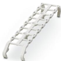
Repères pour blocs de jonction, blanc, repéré, type de montage: encliquetage, pour bloc de jonction au pas de : 8 mm, surface utile: 2,4 x 9,2 mm, Nombre d'étiquettes: 2
