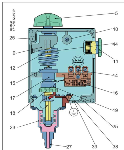
Le soufflet du régulateur de pression RT est connecté, au moyen du raccord, au côté basse ou haute pression du système contrôlé.
