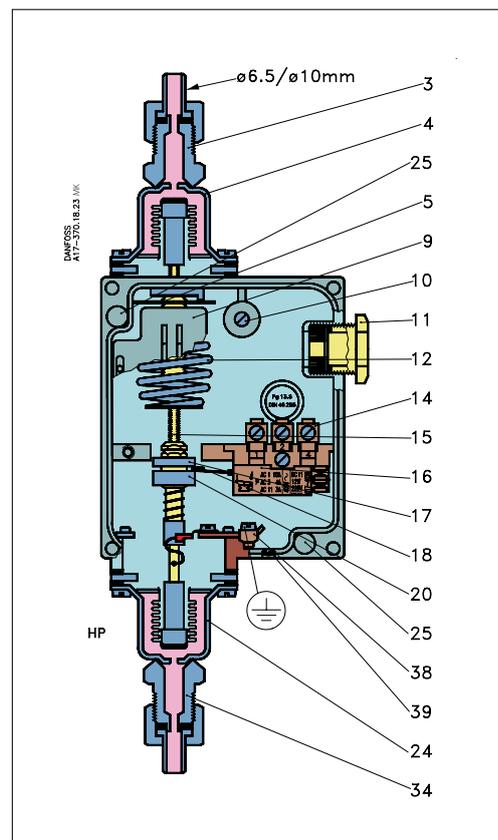
Un régulateur de pression différentielle RT contient un inverseur unipolaire qui ferme ou ouvre le circuit électrique en fonction du différentiel de pression entre les deux soufflets à effet opposé (BP et HP).
