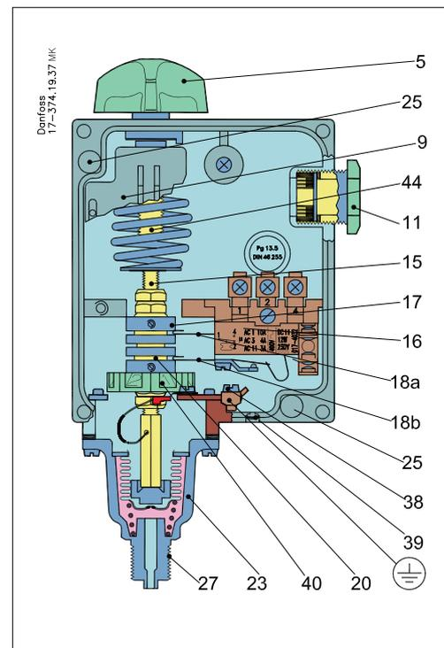
Les régulateurs de pression RT L sont munis d'un contact avec zone neutre ajustable. Les appareils peuvent ainsi être utilisés en régulation flottante. Les bras de contact du système de contact à zone neutre (18a) et (18b) sont manœuvrés par les rouleaux d'entraînement de la tige (17) et (20).
