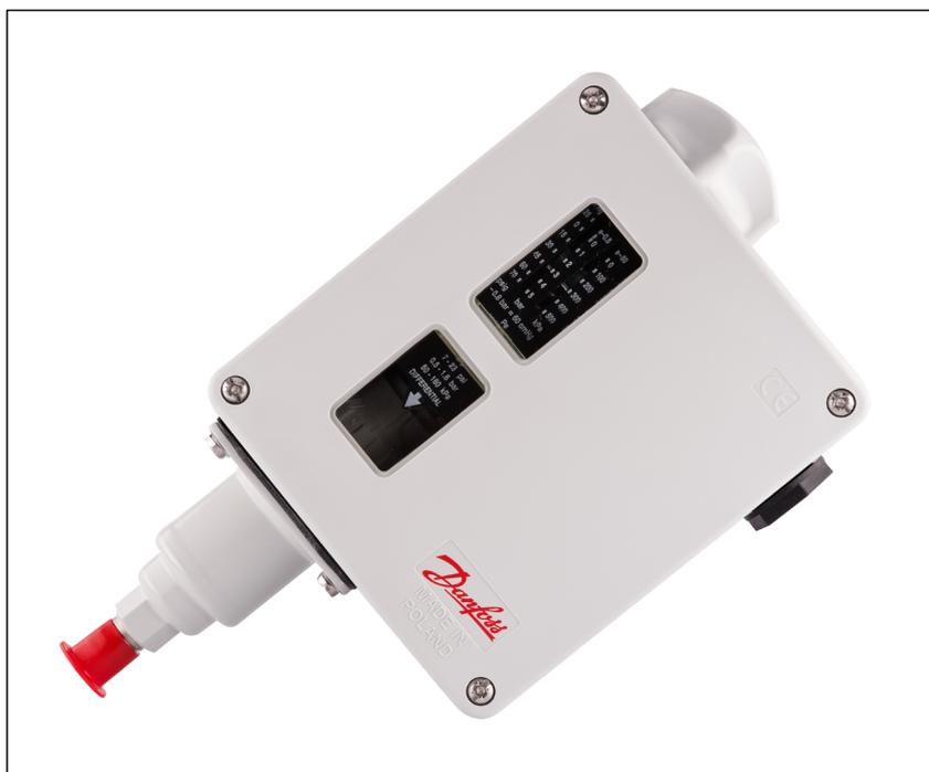
Un régulateur de pression RT renferme un contact inverseur unipolaire dont la position est fonction de la pression dans le raccord d'entrée et de la valeur réglée sur l'échelle.
