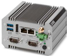
Box PC industriel (BPC) sans ventilateur, à indice de protection IP30 et processeur Intel® Celeron® N3350 à haut rendement énergétique, mémoire de masse eMMC de 32 Go, SSD M.2 de 64 Go, 2 ports COM et système d'exploitation Windows 10 Enterprise 2019 LTSC
