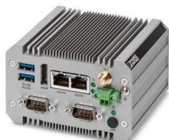
Box PC industriel (BPC) sans ventilateur, à indice de protection IP30 et processeur Intel® Celeron® N3350 à haut rendement énergétique, mémoire de masse eMMC de 32 Go, un emplacement ouvert M.2 et 2 ports COM
