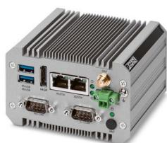
Box PC industriel (BPC) sans ventilateur, à indice de protection IP30 et processeur Intel® Celeron® N3350 à haut rendement énergétique, mémoire de masse eMMC de 32 Go, SSD M.2 de 64 Go, 2 ports COM, système d'exploitation Windows 10 Enterprise 2019 LTSC et module Trusted Platform (TPM)
