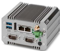
Box PC industriel (BPC) sans ventilateur, à indice de protection IP30 et processeur Intel® Celeron® N3350 à haut rendement énergétique avec mémoire de masse eMMC de 32 Go, SSD M.2 de 128 Go, 2 ports COM et système d'exploitation Windows 10 Enterprise 2019 LTSC
