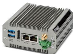
Box PC industriel (BPC) sans ventilateur, à indice de protection IP30, processeur Intel® Celeron® N3350 à haut rendement énergétique et mémoire de masse eMMC de 32 Go
