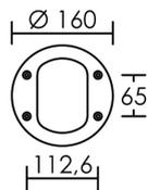
Corps aluminium extrudé/Diffuseur polycarbonate opale. **LED SÉOUL**. Alimentation intégrée.
