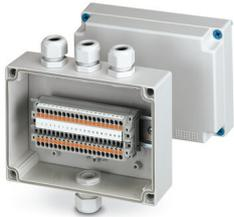
Coffret de commande, avec 20 blocs de jonction de 2,5 mm<sup>2</sup> à raccordement Push-in, matériau: ABS, gris, 180 mm x 130 mm x 100 mm, type de verrouillage: Couvercle vissé
