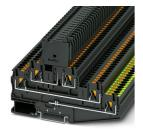
Bloc de jonction-fusibles, type de fusible: Verre / Céramique / ..., type de fusible: G / 5 x 20, tension nominale: 60 V, intensité nominale: 6,3 A, type de raccordement: Raccordement Pushin, Section de référence: 4 mm², section : 0,2 mm²- 6 mm², type de raccordement: Raccordement Push-in, section : 0,2 mm²- 6 mm², type de montage: NS 35/7,5, NS 35/15, coloris: noir
