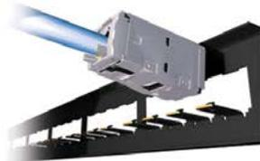
El contacto entre la pestaña de puesta a tierra del módulo y el pestillo del panel de conexión proporciona la unión necesaria para la puesta a tierra
