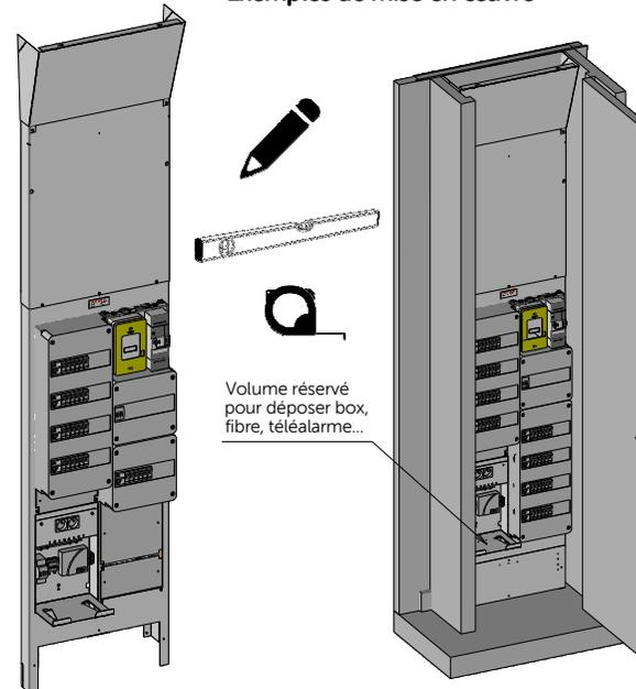
Volume réservé pour déposer box, fibre, téléalarme...
