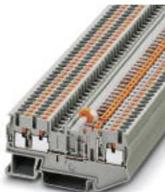
Bloc de jonction à couteau de sectionnement, Mode de raccordement: Raccordement Push-in, Section :0,14 mm<sup>2</sup> - 4 mm<sup>2</sup>, AWG: 26 - 12, Intensité nominale: 20 A, Tension nominale: 400 V, Longueur: 74 mm, Largeur: 5,2 mm, Coloris: gris, Montage: NS 35/7,5, NS 35/15
