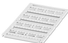
Repères pour blocs de jonction, à commander : sous forme de planche, blanc, impression selon les indications du client, type de montage: encliquetage dans la rainure de repérage plate, pour bloc de jonction au pas de : 5,2 mm, surface utile: 4,6 x 5,1 mm, Nombre d'étiquettes: 96
