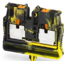
Bloc de jonction miniature, tension nominale: 800 V, intensité nominale: 24 A, nombre de connexions: 2, nombre de pôles: 1, type de raccordement: Raccordement Push-in, Section de référence: 2,5 mm<sup>2</sup>, section : 0,14 mm<sup>2</sup> - 4 mm<sup>2</sup>, type de montage: Montage du crochet d'encliquetage, coloris: noir/jaune
