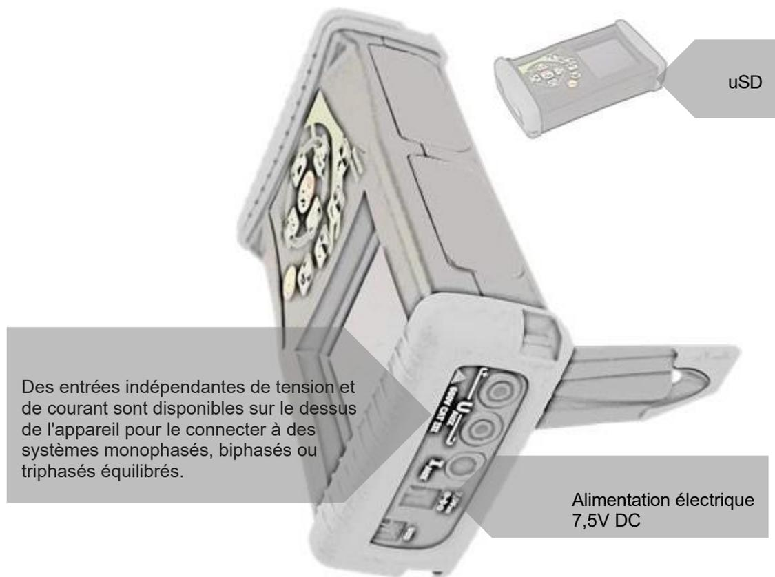
Des entrées indépendantes de tension et de courant sont disponibles sur le dessus de l'appareil pour le connecter à des systèmes monophasés, biphasés ou triphasés équilibrés.
