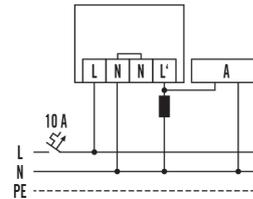
Raccordement d'inductances (par ex. relais, contacteur, ballast) peut nécessiter l'insertion d'un circuit RC (A).
