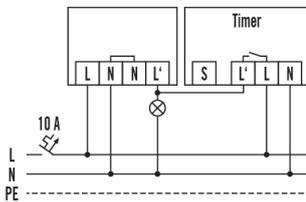
Raccordement en parallèle sur minuterie.
