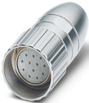
M23, Connecteurs à câble, droit, blindé: non, Verrouillage à vis, Nombre de pôles: 12, Sens de rotation: inversé, type de contact: Connecteur femelle, Cône de soudage, plage de diamètre de câble: 3 mm ... 10,5 mm, détrompage: N, Produit de remplacement selon RoHS II sans exception 6c (Pb < 0,1 %) référence : 1241128
