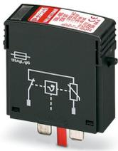
Fiche de protection antisurtension de type 2, avec varistance haute performance pour embase VAL-MS, surveillance thermique, signalisation optique de défaut. Version : 230 V AC
