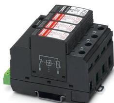
Module de protection composé d'une embase avec contact de signalisation à distance et de fiches de protection, pour montage sur NS 35/7,5, tension nominale : 230 V AC, montage 3+1
