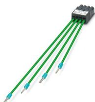
Jeu de câbles destiné à la transmission des signaux et l'alimentation en tension sur le Termination Carrier pour modules de la série MINI Analog et PSR Mini. Raccordement des points de connexion 5 et 6 (transmission de signaux) ainsi que 7 et 8 (alimentation en tension) au circuit imprimé de signalisation.
