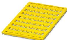
Repères pour blocs de jonction, Planche, jaune, vierge, repérable avec : BLUEMARK ID, BLUEMARK ID COLOR, BLUEMARK CLED, PLOTMARK, CMS-P1-PLOTTER, type de montage: encliquetage, pour bloc de jonction au pas de : 5 mm, surface utile: 8 x 4 mm, Nombre d'étiquettes: 96
